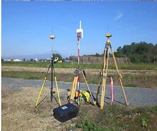
3・4級基準点測量に使用する GNSS 測量機器
