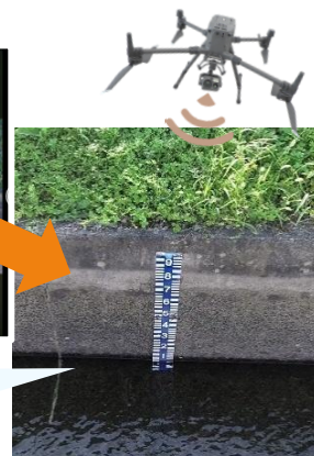
UAV 自動撮影画像（水位標）
