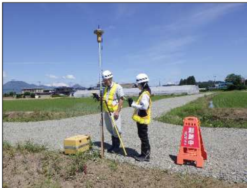
確測基準点への GNSS 測量機器の設置状況
